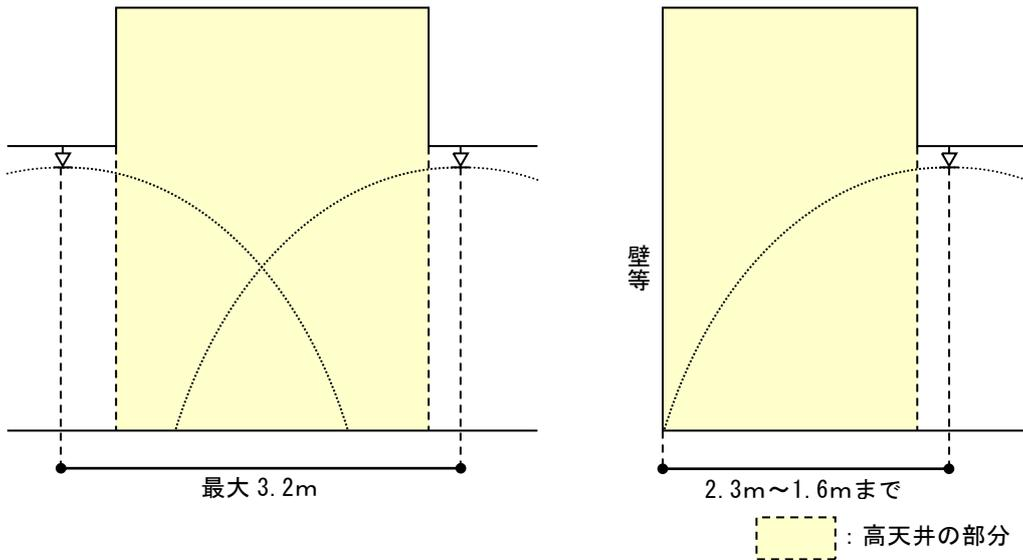
(高感度型ヘッド有効散水半径 2.6m の場合の設置例 [格子型配置の場合])
