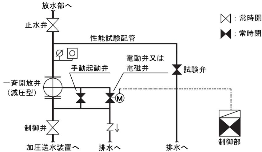
(電動弁又は電磁弁方式回りの配管例)
