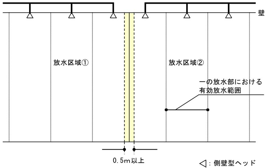
(その2) 放水区域が相互に重複する部分を、逆止弁を用いて一の固定式ヘッドで有効放水範囲となるよう設ける場合
