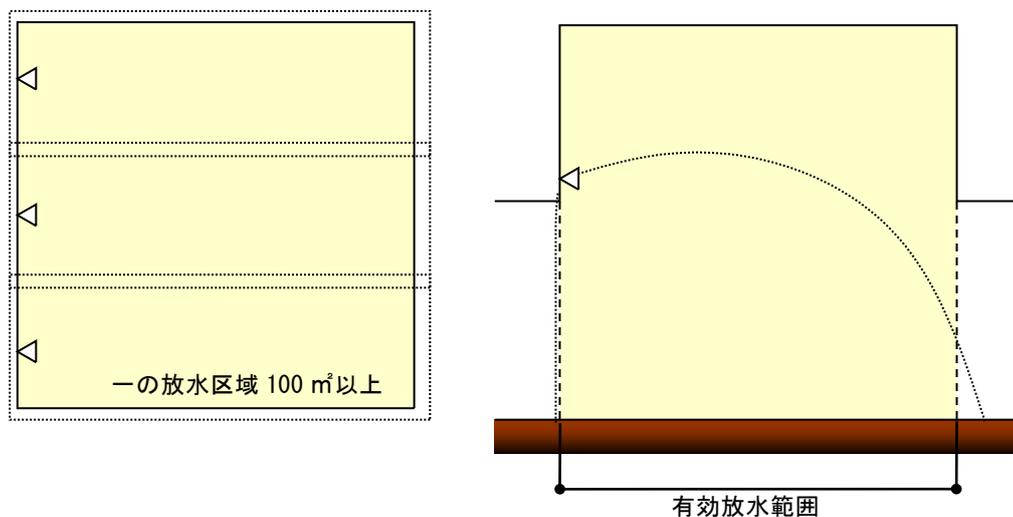
(その3) 固定式ヘッドの種類が側壁型(対列方式)の場合
