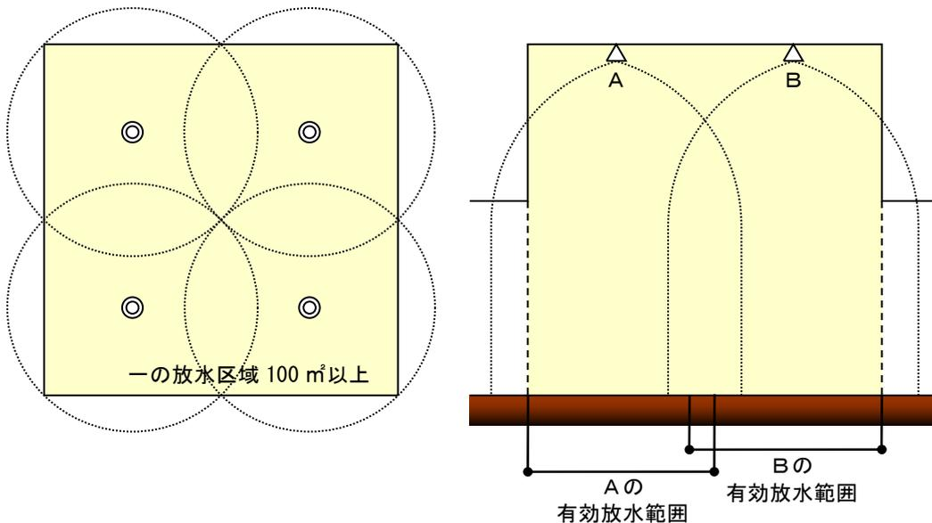
(その2) 固定式ヘッドの種類が側壁型（一列方式）の場合
