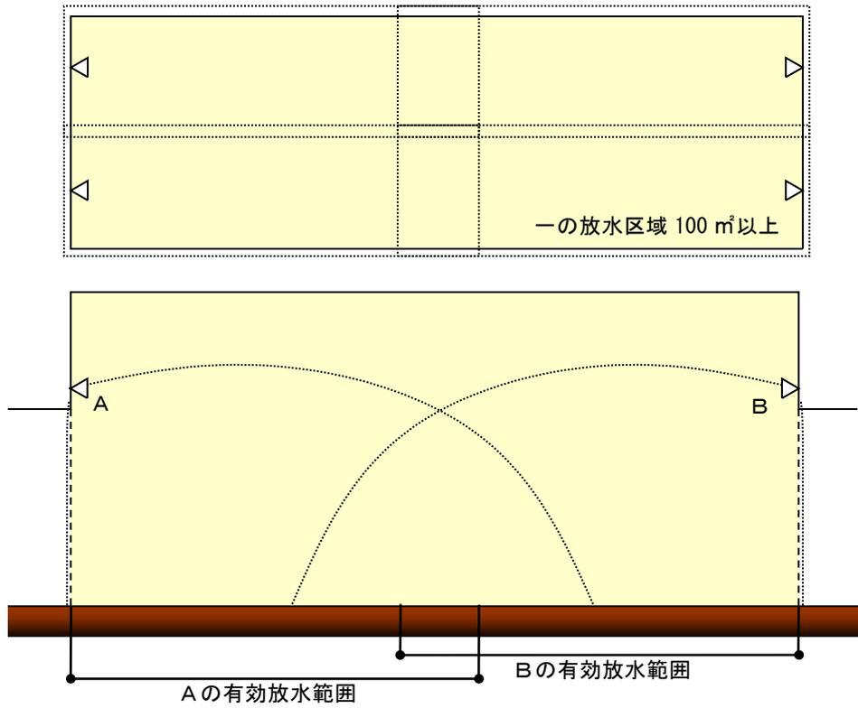
(その4) 固定式ヘッドの種類が天井型及び側壁型の場合
