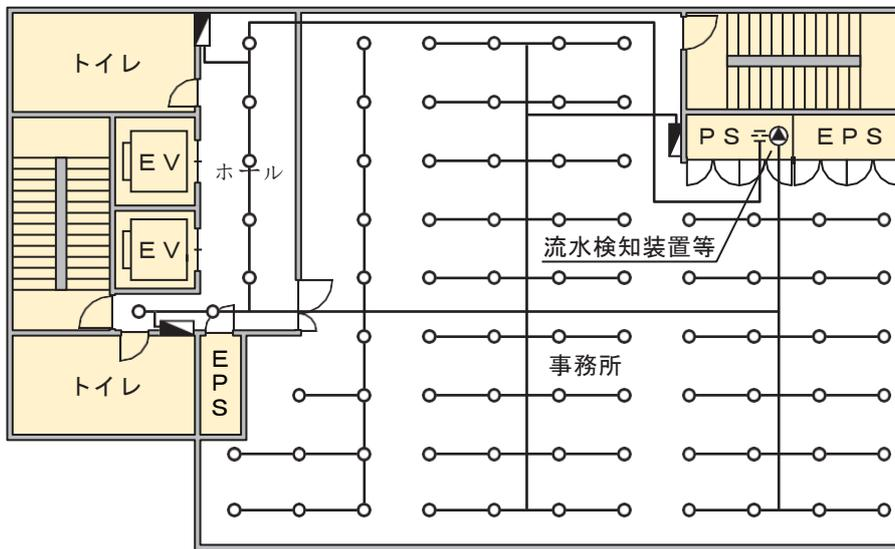
※一の流水検知装置等が受け持つ区域は、省令第13条第3項の規定により、ヘッドを設けない部分（黄色部分）の床面積を含めること。
