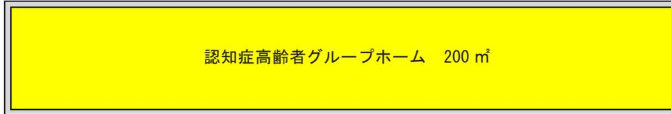
基準面積 1,000 m<sup>2</sup>未満であるが、政令第 11 条第 1 項第 6 号の規定（無窓階で、床面積が 150 m<sup>2</sup>以上の(6)項口に掲げる防火対象物）に該当するため、当該防火対象物に屋内消火栓設備を設置する。
