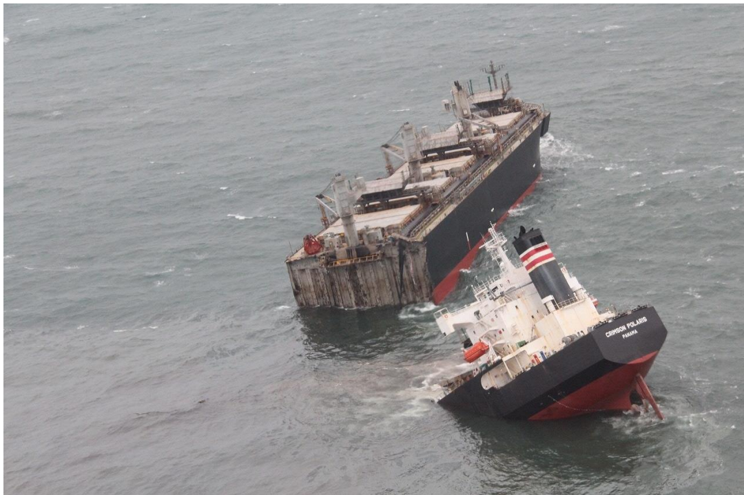
写真1 船体破断直後の状況(8月12日午前7時頃)
