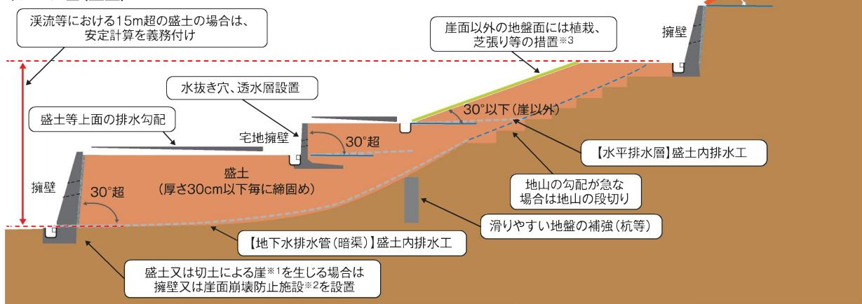
※1「崖」とは、地表面が水平面に対し30°を超える角度をなす土地で、硬岩盤(風化の著しいものを除く)以外のものをいいます。※2 住宅等の建築物を建築する地盤には崖面崩壊防止施設(鋼製枠工等)は設置できません。※3 道路の路面の部分その他の植栽、芝張り等の措置の必要がないことが明らかな地盤面を除きます。
