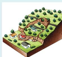
斜面の一部あるいは全部が地下水の影響と重力によってゆっくりと斜面下方に移動する現象です。
