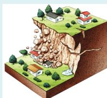
斜面の地表に近い部分が、雨水の浸透や地震等でゆるみ、突然、崩れ落ちる現象です。
