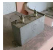
溶接機から取り出したコンデンサー
