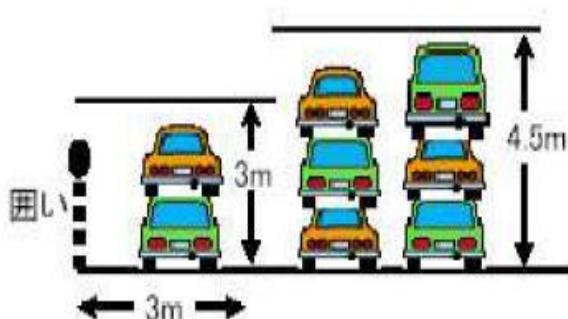
※ 構造耐力上安全なラック等を使用して保管する場合は、解体自動車の搬出入に当たり、解体自動車の落下による危害が生ずるおそれのない高さまで
