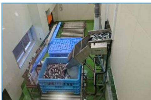
④ 流動海水氷と魚体の容器入れ (自動計量)
