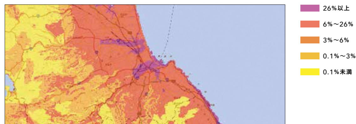
〔図57〕 八戸市周辺で30年以内に震度6弱以上の地震が起きる確率の分布
