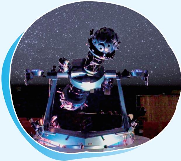
2階のプラネタリウム室では、光学式の恒星投影機「MS-10」を使用し、人間が目で見ることが出来る星の数と同程度の、およそ6,000個の星を映すことができます。
