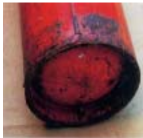
溶接部及び その周辺の剥離
